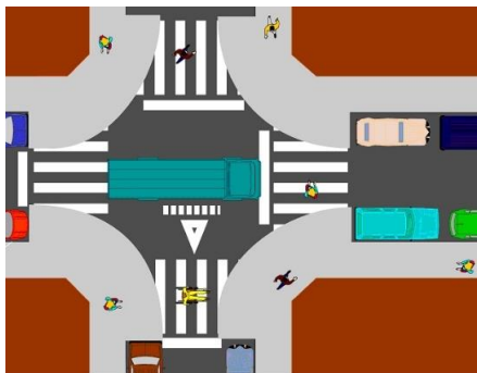
Figura 45. Intersecció compacta i segura
