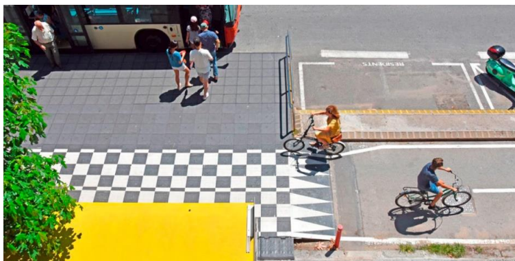
Imatge 53. Exemple de carril integrat a Barcelona. Plataforma per accedir l'autobús i integració del carril pedalable. Solució de Zicla, Sistema Vectorial
