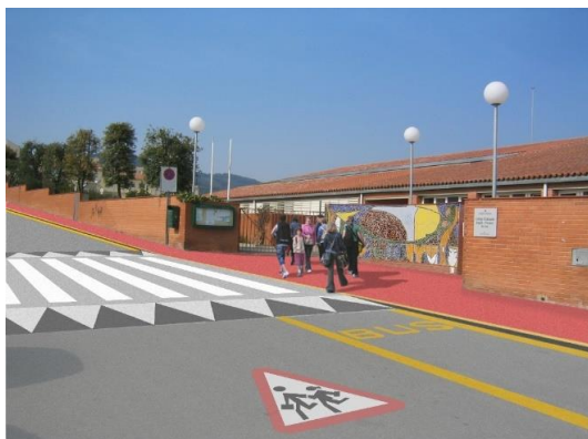
Figura 70. Fotomuntatge proposta de plataforma elevada que cobreixi tot l'entorn d'accés a l'escola i que inclogui parada de transport col·lectiu i diferents elements de mobiliari urbà
