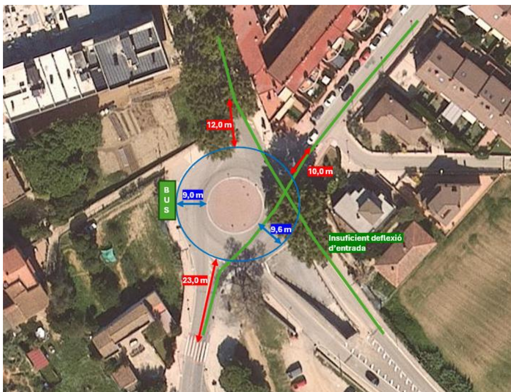
Figura 21. Disfuncions detectades a la rotonda
