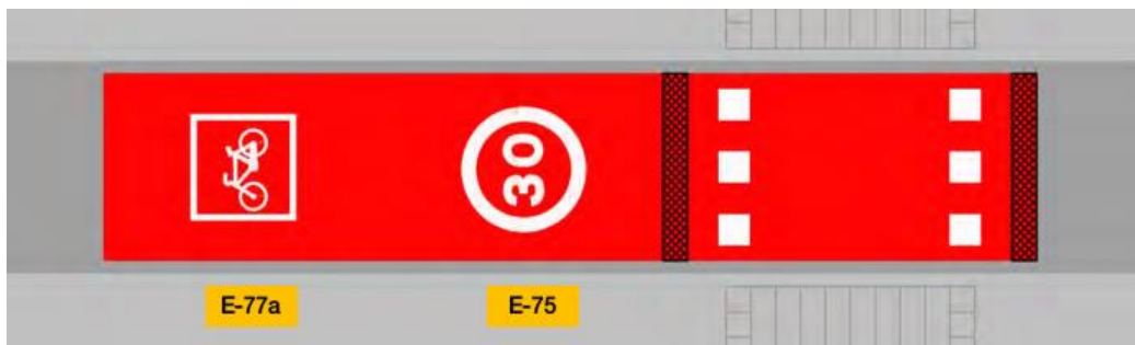
Figura 58. Exemple d'accés a carrer de zona 30: Pas de vianants elevat per reduir la velocitat dels vehicles i senyalització horitzontal
