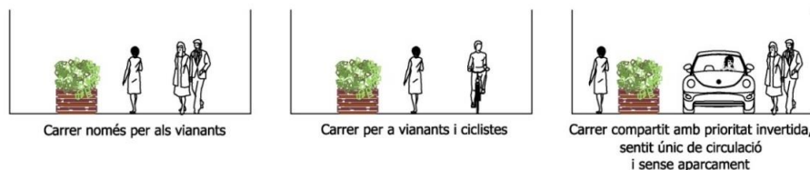
Figura 27. Possibles seccions per a carrers amb menys de 7 m d'amplada
