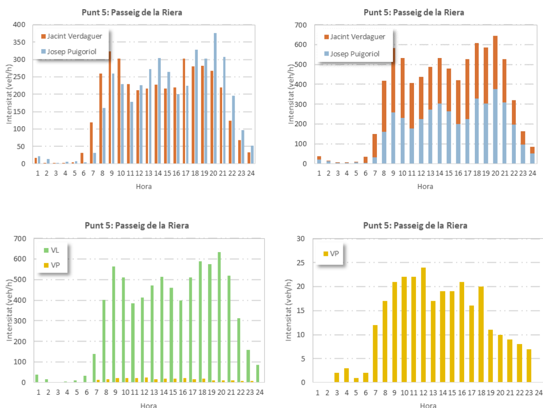
Figura 6.— Distribució horària i tipus de vehicle al punt d'aforament 5. Font: elaboració pròpia
