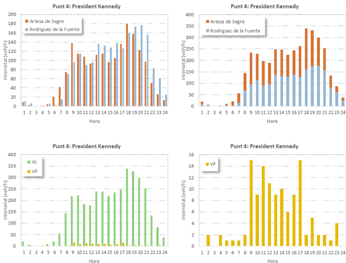
Figura 5.- Distribució horària i tipus de vehicle al punt d'aforament 4. Font: elaboració pròpia
